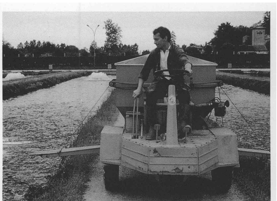
Distribution mécanisée d'aliment sur une salmoniculture. Les quantités d'aliment distribué, la fréquence des repas, la durée des repas (liée à la vitesse de passage de l'engin) doivent être programmés quotidiennement en fonction des conditions climatiques.
